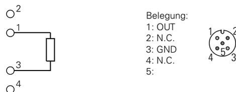
Bild 3-7: Beschaltung für Module Strom- und Spannungsausgang
